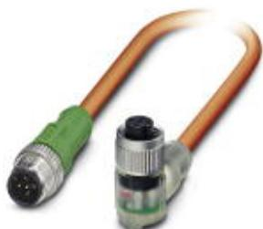
Кабель для датчика / исполнительного элемента, 5-полюсн., PUR без галогенов, устойчив к сварочному грату, оранжевый RAL 2003, Штекеры прямое M12, А-кодирование, к Гнездо угловой M12, А-кодирование, с 3 светодиода, длина кабеля: 2 м, для использования на роботах и тяговых цепях
