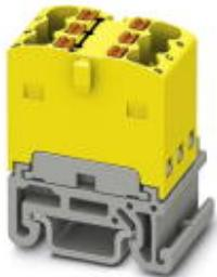
Распределительный блок, с внутренней перемычкой, Блоки можно шунтировать между собой, используя отверстия клеммы. Подходящие перемычки см. в принадлежностях, номинальное напряжение: 500 В, номинальный ток: 17,5 А, тип подключения: Зажимы Push-in, количество точек подсоединения: 6, сечение: 0,14 мм<sup>2</sup> - 2,5 мм<sup>2</sup>, AWG: 26 - 14, ширина: 12,5 мм, цвет: желтый, тип монтажа: NS 15
