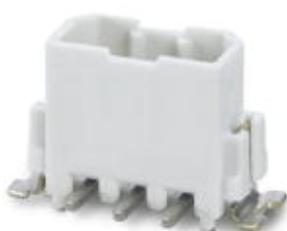
Корпусная часть для печатных плат, номинальный ток: 6 А, расчетное напряжение (III/2): 160 В, полюсов: 4, размер шага: 2,5 мм, цвет: белый, поверхность контакта: олово, монтаж: SMD пайка, Артикул с защитными стопорными штифтами
