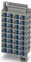
Сотовые клеммы, номинальное напряжение: 500 В, номинальный ток: 17,5 А, сечение: 0,14 мм<sup>2</sup> - 2,5 мм<sup>2</sup>, AWG: 14 - 26, тип подключения: Зажимы Push-in, полюсов: 32, количество подключений: 128, ширина: 44 мм, длина: 73,2 мм, цвет: серый, цвет элементов подключения: синий, монтаж: Настенный монтаж
