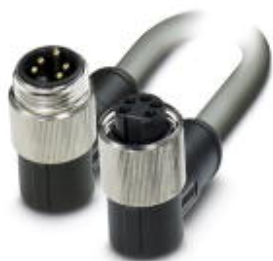
Силовой кабель, 5-полюсн., ПВХ, серый RAL 7001, Штекеры угловой 7/8"-16UNF, к Гнездо угловой 7/8"-16UNF, длина кабеля: 0,6 м, сечение жилы 1,5 мм², для питания
