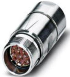
Переходные соединители, прямой, Винтовой зажим, M23, полюсов: 12, тип контактов: Штифт, Обжим, экранирован.: есть, диапазон диаметра кабеля: 5 мм ... 13,2 мм
