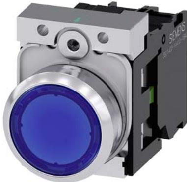
Нажимная кнопка с сигнализацией, 22 мм, кругл., металл, глянец., цвет: синий, кнопка, плоск., нажатием на кнопку, с держателем, 1 НО, Светодиодный модуль со встроенным светодиодом, 24 В AC/DC винтовой зажим
