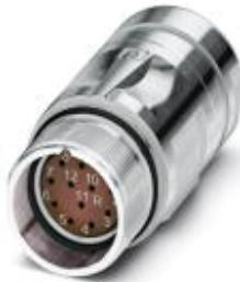
Переходной соединитель, прямой, экранирован.: есть, для стандартной блокировки и SPEEDCON, M23, Полосов: 12, тип контактов: Розетка, Обжим, диапазон диаметра кабеля: 3 мм ... 14,5 мм
