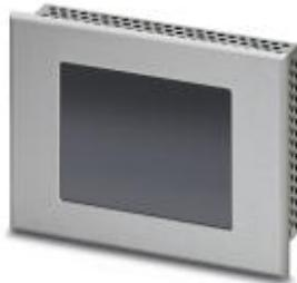
Сенсорная панель с 8,9 см / 3,5"-TFT-дисплей (аналого-резистивные (полиэфир)), 320 x 240 Пиксел (QVGA), 65536 цветов, Arm9™, 200 МГц, 2x USB Host 2.0, 1x Ethernet (10/100 Мбит/с), RJ45, Windows CE 5.0 и прикладное ПО: TSvisRT. (шинная система: без)
