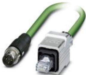
Сетевой кабель, PROFINET CAT5 (100 Мбит/с), EtherCAT® CAT5 (100 Мбит/с), 4-полюсн., ПВХ/ПВХ, зеленый RAL 6018, экранирован., Штекеры прямое M12 SPEEDCON / IP67, механические ключи: D, к Штекеры прямое RJ45 Крепление на защелках / IP67, длина кабеля: 5 м
