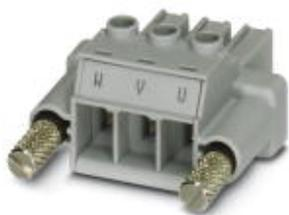
Разъемы для печатной платы, номинальный ток: 41 А, расчетное напряжение (III/2): 1000 В, полюсов: 3, размер шага: 7,62 мм, тип подключения: Винтовой зажим с натяжной гильзой, цвет: серый, поверхность контакта: олово, Набивка: W V U; Особый винт: M3 с накатанной головкой
