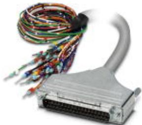
Подготовленный экранированный круглый кабель; Подключение 1: отдельные жилы (37-полюсн.) (Жилы промаркированы и оснащены наконечниками.); Подключение 2: Штыревой разъем D-SUB (1x 37-полюсн.); длина кабеля: 3 м
