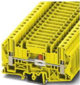
Клемма с размыкателем , тип подключения: Винтовые зажимы, сечение: 0,2 мм<sup>2</sup> - 10 мм<sup>2</sup> , AWG: 24 - 8, ширина: 8,2 мм, тип монтажа: NS 35/7,5, NS 35/15, NS 32, цвет: желтый
