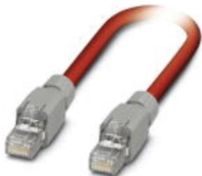
Готовый кабель Sercos III, экранированный, четверка звездной скрутки, AWG 22, гибкий (7-проводочный), RAL 3020 (транспортный красный), на одном конце штекер RJ45/IP20, на другом - штекер RJ45/IP20, длина: 2 м
