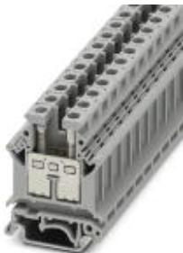
Проходные клеммы, с винтами для крепления контрольного штекера справа, номинальное напряжение: 800 В, номинальный ток: 76 А, тип подключения: Винтовые зажимы, количество точек подсоединения: 2, сечение: 0,5 мм<sup>2</sup> - 16 мм<sup>2</sup>, AWG: 20 - 6, ширина: 10,2 мм, цвет: серый, тип монтажа: NS 35/7,5, NS 35/15, NS 32
