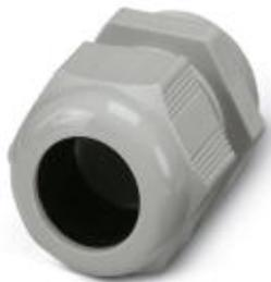
Кабельный ввод, материал резьбового соединения: PA, наружный диаметр кабеля 18 мм ... 25 мм, экранировка: нет, резьба соединительной части: M32 x 1,5, цвет: светло-серый, RAL 7035
