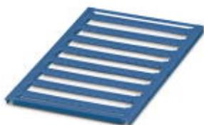
Маркировка для клеммных модулей, возможен заказ: в пластинах, синий, надписи в соответствии с требованиями заказчика, тип монтажа: крепление в плоских пазах для табличек, для клемм шириной: 5,2 мм, размер маркировочного поля: 4,6 x 5,1 мм
