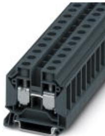
Проходные клеммы, номинальное напряжение: 1000 В, номинальный ток: 76 А, тип подключения: Винтовые зажимы, количество точек подсоединения: 2, сечение: 6 мм<sup>2</sup> - 16 мм<sup>2</sup>, AWG: 10 - 6, ширина: 12,2 мм, цвет: синий, тип монтажа: NS 35/7,5, NS 35/15, NS 32
