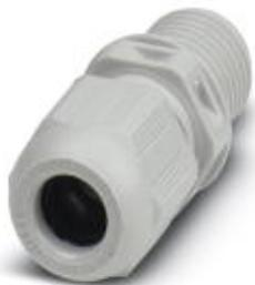
Кабельный ввод, материал резьбового соединения: PA, наружный диаметр кабеля 4,5 мм ... 10 мм, экранировка: нет, резьба соединительной части: M16 x 1,5, цвет: светло-серый, RAL 7035
