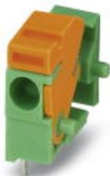
Клеммы для печатной платы, номинальный ток: 15 А, номинальное напряжение: 320 В, размер шага: 5,08 мм, полюсов: 4, тип подключения: Пружинные зажимы Push-in, монтаж: Пайка волной припоя, направление подключения, проводник/печатная плата: 0 °, цвет: зеленый
