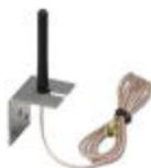
Всенаправленная антенна, 2,4 ГГц, коэфф. усиления: 2 дБи, поляризация: линейная, угол раскрытия гор./ верт. 360°/75°, степень защиты: IP65, подключение: RSMA (штыревой), вкл. кабель подключения 1,5 м и монтажный уголок для настенного монтажа
