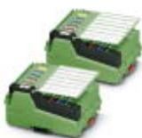
Комплект Wireless-MUX, два модуля, каждый с 16 цифровыми входами и выходами и 2 аналоговыми входами и выходами (0-20 мА, 0-10 В), без антенн
