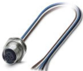
Встр. гнездо часть для датчика/исп. устр-ва, 5-контактн., M12-SPEEDCON, с механич. ключом В, монтаж на задней панели/резьбовое крепление M16, с гибким проводом 0,5 м (TPE), 5 x 0,34 мм<sup>2</sup>
