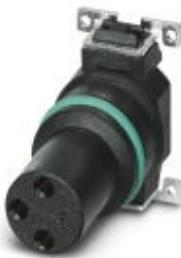
Встраиваемые разъемы, 3-полюсн., Гнездо, прямое, M8, А-кодирование, Монтаж на печатную плату, SMD
