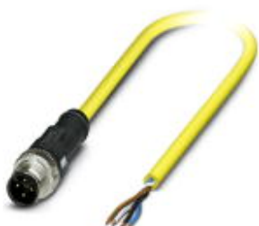
Кабель для датчика / исполнительного элемента, 4-полюсн., ПВХ, желтый, Штекеры прямое M12 SPEEDCON, A-кодирование, к свободный конец, длина кабеля: 10 м
