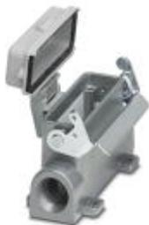
Приборный корпус D25, с одной защелкой, материал: Алюминиевое литье под давл., материал, защитная крышка: PA, длина кабеля: 1, слева (вид на открытую плоскую скобку), высота: 57 мм, кабельный ввод: без, патрубков: да, 1x Pg21, защитная крышка: да, Стандартн.
