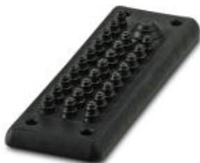
Панель кабельных вводов, количество проводов: 27, длина: 154 мм, ширина: 56 мм, высота: 18,5 мм, наружный диаметр проводника: 26x 3 мм ... 6 мм, цвет: черный
