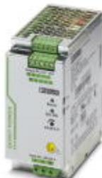
Блок питания QUINT POWER для установки на несущую рейку с технологией SFB (Selective Fuse Breaking), первичный такт, с защитным покрытием, вход: 1-фазный, выход: 24 В DC / 10 А
