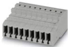
Соединитель COMBI, номинальное напряжение: 800 В, номинальный ток: 32 А, тип подключения: Пружинный зажим, количество точек подсоединения: 2, полюсов: 9, сечение: 0,08 мм<sup>2</sup> - 6 мм<sup>2</sup>, AWG: 28 - 10, ширина: 55,8 мм, высота: 22,3 мм, цвет: серый
