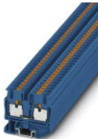
Проходная мини-клемма, номинальное напряжение: 500 В, номинальный ток: 24 А, тип подключения: Зажимы Push-in, количество точек подсоединения: 2, сечение: 0,14 мм<sup>2</sup> - 4 мм<sup>2</sup>, AWG: 26 - 12, ширина: 5,2 мм, высота: 32,1 мм, цвет: синий, тип монтажа: NS 15
