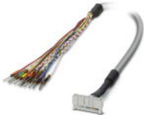
Подготовленный круглый кабель; Подключение 1: отдельные жилы (16-полюсн.) (Жилы промаркированы и оснащены наконечниками.); Подключение 2: IDC/FLK коммутационная плата (1x 16-полюсн.); длина кабеля: 2,5 м
