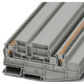
Проходные клеммы, тип подключения: Зажимы Push-in, сечение: 0,2 мм<sup>2</sup> - 6 мм<sup>2</sup>, AWG: 24 - 10, ширина: 6,2 мм, цвет: серый, тип монтажа: NS 35/7,5, NS 35/15
