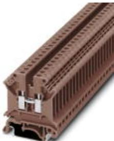
Проходные клеммы, номинальное напряжение: 800 В, номинальный ток: 32 А, тип подключения: Винтовые зажимы, количество точек подсоединения: 2, сечение: 0,2 мм<sup>2</sup> - 6 мм<sup>2</sup>, AWG: 24 - 10, ширина: 6,2 мм, цвет: коричневый, тип монтажа: NS 35/7,5, NS 35/15, NS 32
