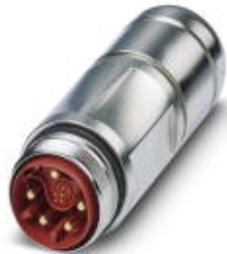
Переходной соединитель, прямой, длинный, экранирован.: есть, для стандартной блокировки и SPEEDCON, M40, Полюсов: 8+4+PE, тип контактов: Штифт, Обжим, диапазон диаметра кабеля: 9 мм ... 14 мм
