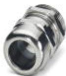
Кабельный ввод, материал резьбового соединения: латунь, никелированный, наружный диаметр кабеля 15 мм ... 21 мм, экранировка: нет, резьба соединительной части: M32 x 1,5, цвет: серебристый, с уплотнительным кольцом
