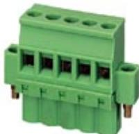
Разъемы для печатной платы, номинальный ток: 12 A, расчетное напряжение (III/2): 320 В, полюсов: 5, размер шага: 5,08 мм, тип подключения: Винтовой зажим с натяжной гильзой, цвет: агатовый серый, поверхность контакта: Золото
