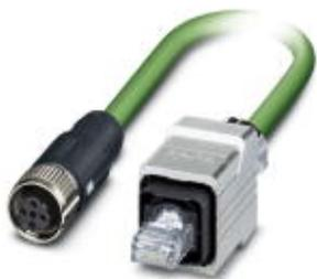
Сетевой кабель, PROFINET CAT5 (100 Мбит/с), EtherCAT® CAT5 (100 Мбит/с), 4-полюсн., ПВХ/ПВХ, зеленый RAL 6018, экранирован., Штекеры прямое RJ45 Крепление на защелках / IP67, к гнездо прямое M12 SPEEDCON / IP67, механические ключи: D, длина кабеля: 2 м
