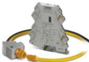
Комплект состоит из усилителя с развязкой 4 цепей с винтовым зажимом и пояса Роговского длиной 300 мм и диаметром 95 мм для измерения переменного тока на сборных шинах и силовых кабелях. На выходе усилитель выдает 8 различных нормированных сигналов и имеет коммутационный выход.
