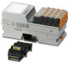
Axioline F, Модуль цифрового ввода, Цифровые входы: 32, 24 В DC, способ подключения: 1-проводной кабель, скорость передачи данных в локальной шине: 100 Мбит/с, степень защиты: IP20, с цокольным модулем шины и штекерами Axioline F
