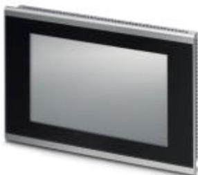
Сенсорная панель с 39,6 см / 15,6"-дисплей (проекционно-ёмкостные (PCAP)), 1366 x 768 Пиксел (WXGA), 65536 цветов, Arm® Cortex®-A8, 1000 МГц, 2x USB Host 2.0, 1x Ethernet (10/100 Мбит/с), RJ45, Windows® Embedded Compact 7 и прикладное ПО: Visu+. (шинная система: без)
