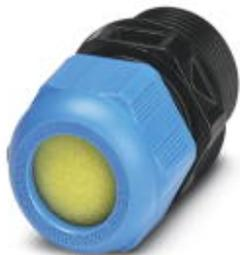
Кабельный ввод, материал резьбового соединения: PA, применение: Ex, наружный диаметр кабеля 17 мм ... 28 мм, экранировка: нет, резьба соединительной части: M40 x 1,5, цвет: черный/синий, с плоским уплотнителем
