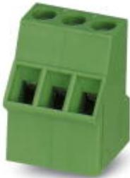
Клеммы для печатной платы, номинальный ток: 20 A, номинальное напряжение: 400 В, размер шага: 5,08 мм, полюсов: 3, тип подключения: Винтовой зажим с натяжной гильзой, монтаж: Пайка волной припоя, направление подключения, проводник/печатная плата: 50°, цвет: черный
