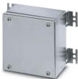
Клеммная коробка, материал: Высококачественная сталь 304 / 1.4301, поверхностное сопротивление: сатинированный, серебристый, 200 мм x 150 мм x 80 мм, тип замка: навинчиваемая крышка, комплект поставки - ATD: Монтажная плата, Крепежный кронштейн в комплекте с винтами, Штифты заземления M12, расположенные снаружи, Инструкция по монтажу, Монтажная плата
