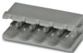
Корпусная часть для печатных плат, номинальный ток: 12 A, расчетное напряжение (III/2): 320 В, полюсов: 2, размер шага: 5 мм, цвет: бело-зеленый, поверхность контакта: олово, монтаж: Пайка волной припоя
