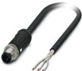
Кабель для датчика / исполнительного элемента, 3-полюсн., PE-X без галогенов, черный, экранирован., Штекеры прямое M12 SPEEDCON, А-кодирование, к свободный конец, длина кабеля: 10 м, для железнодорожного транспорта
