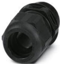
Кабельный ввод, материал резьбового соединения: PA, применение: Ex, наружный диаметр кабеля 17 мм ... 28 мм, экранировка: нет, резьба соединительной части: M40 x 1,5, цвет: черный, с плоским уплотнителем
