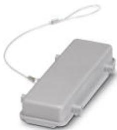
Защитная крышка B24, крепление двумя защелками, материал, защитная крышка: PA, высота: 18 мм, уплотнение: нет, со шнурком, диаметр кольца: 30 мм
