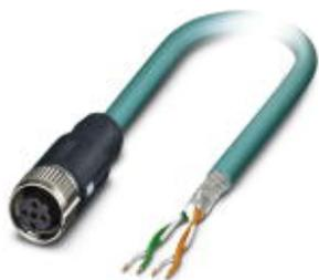
Сетевой кабель, Ethernet CAT5 (100 Мбит/с), 4-полюсн., PUR, цвет морской воды RAL 5021, экранирован., свободный конец, к гнездо прямое M12 SPEEDCON / IP67, механические ключи: D, длина кабеля: 2 м
