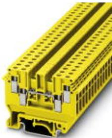
Проходные клеммы, номинальное напряжение: 630 В, номинальный ток: 32 А, тип подключения: Винтовые зажимы, количество точек подсоединения: 4, полюсов: 1, сечение: 0,2 мм<sup>2</sup> - 6 мм<sup>2</sup>, AWG: 24 - 10, ширина: 6,2 мм, цвет: желтый, тип монтажа: NS 35/7,5, NS 35/15, NS 32
