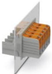
Проходная клемма, тип подключения: Разъем T-LOX с коленчатым рычагом, Подсоединение кабельного наконечника, полюсов: 3, ток нагрузки: 150 A, сечение: 10 mm<sup>2</sup> - 50 mm<sup>2</sup>, ширина: 78 mm, цвет: серый
