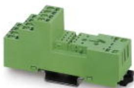
Установочный блок (основание) PR2-B для промышленных реле REL-IR с 2 или 4 переключающими контактами, 1/3-ярусное исполнение, пружинные зажимы, возможность установки вводных модулей и модулей подавления помех, монтируется на NS 35/7.5
